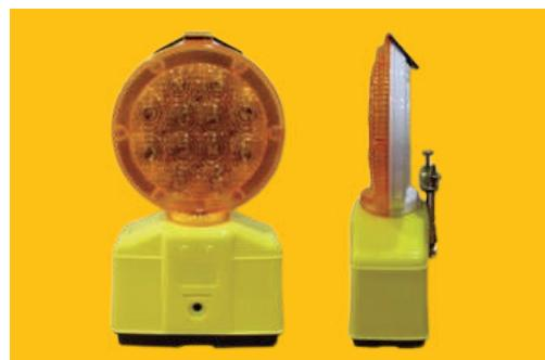
Baliza luminosa de 12 Leds, efecto lupa y doble destello Alta potencia y funcionamiento Dia/Noche o solo Noche Alta visibilidad incluso en condiciones adversas (lluvia, niebla, etc) 1 o 2 Pila Kompact 6V/50Ah. Soporte de Fijación.
